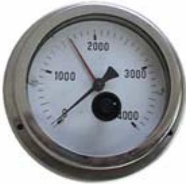
El manómetro control de presión es un instrumento electro-hidráulico que envía una señal electrónica a la máquina cuando el sistema hidráulico llega a la presión seleccionada.
